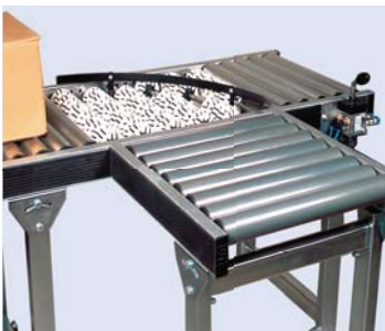
Rollenbahnabzweigung über Allseitenrollen
