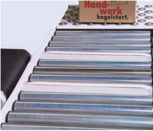
Zahnriemenförderer als Winkelübergabe mit pneumatischem Hub. Toothed belt conveyor as angular transfer with pneumatic lift.
