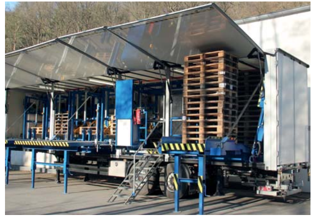
Vollautomatische Palettensortieranlage auf einem Trailer Fully automatic pallet-sorting facility mounted on a trailer
