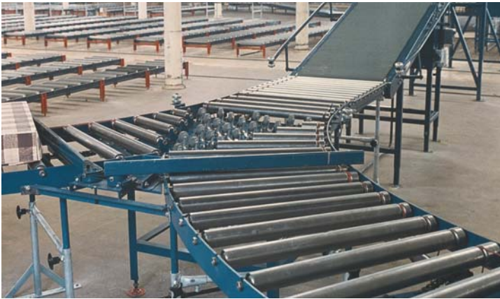
Behältertransportanlage mit Zuteilsperre und Einlaufweiche Box transportation installation with allotting lock and feeding turnout
