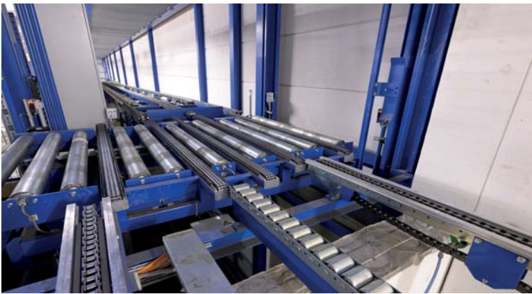
Winkelübergabe mit pneumatisch heb- senkbarer Rollenbahn Angle transfer with pneumatic raisable roller conveyor
