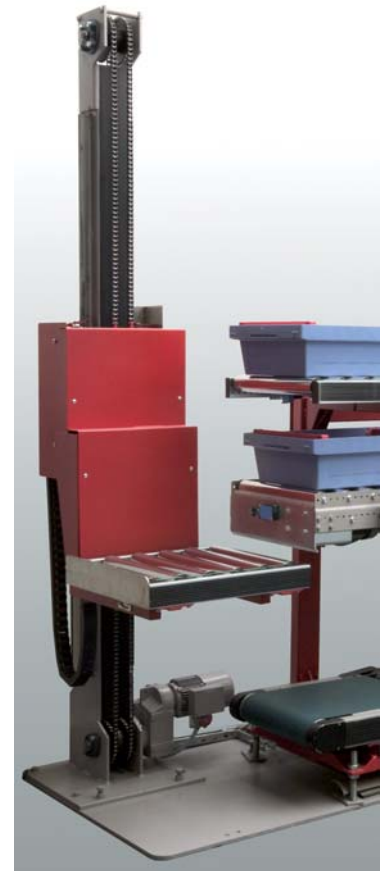
Einsäulensenkrechtförderer zur Beschickung von mehreren, übereinander angeordneten Förderebenen.
