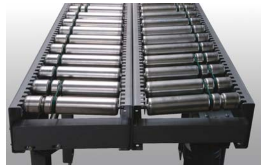
Zweigeteilte Schrägrollenbahn zum mittigen Ausrichten des Fördergutes.
