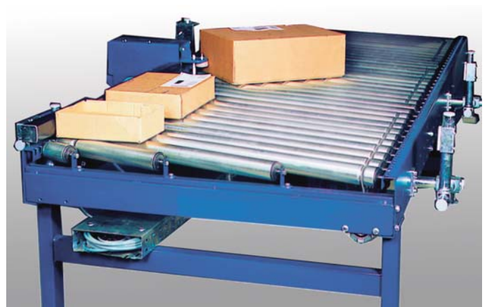
Schrägrollenbahn mit pneumatisch zustellbarer Umlenkrolle zum wahlweisen Ändern der Laufrichtung des Fördergutes.
