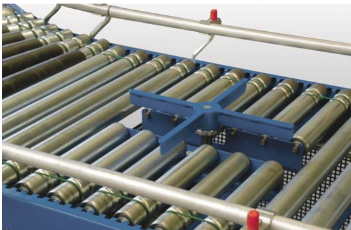
Hub- Drehkreuz eingebaut in eine Rollenbahn zum Ändern der Laufrichtung des Fördergutes.
