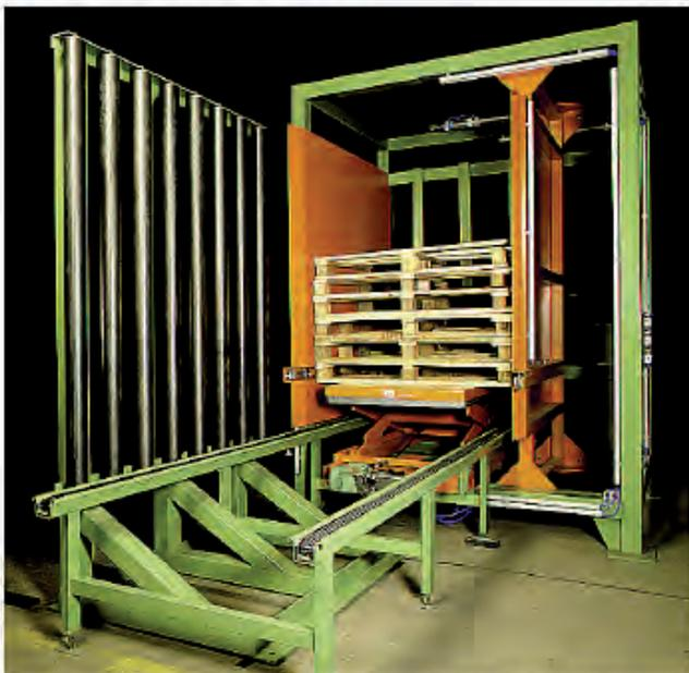
Eine Variante, die auf unterschiedliche Palettenformate eingestellt werden kann. Per Gabelstapler wird der Stapel auf dem Kettenförderer abgesetzt und mit diesem in den Schacht hineingefahren. Das Greiferniveau wird durch die integrierte Scherenhebebühne erreicht.
