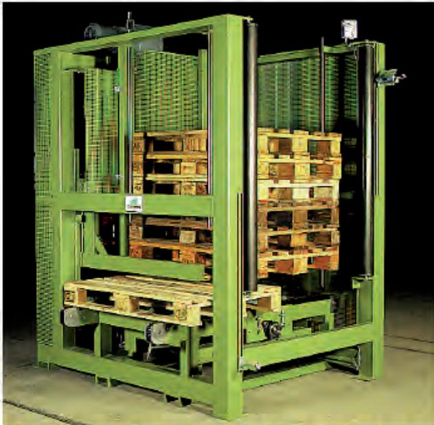
Die Einlagerung erfolgt in Längsrichtung, die Abgabe in Querrichtung. Um die Vereinzeln vornehmen zu können, wird der Stapel innerhalb des Schachtes über elektromotorische Greifer angehoben.
