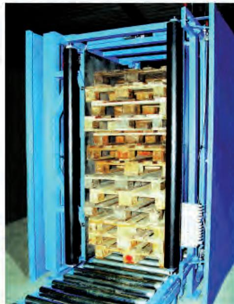
Mit dem Stapelausrichter werden ungeordnete Stapel per Knopfdruck längs und quer zentriert. Die Holzpaletten sollten jedoch nicht zu stark beschädigt sein. Bis zu 15 Paletten kann der Schacht aufnehmen und zu einem sauberen Stapel formen.
