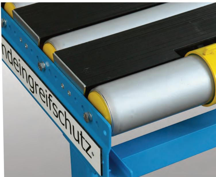
Durch die schon erwähnten Maßnahmen werden Verletzungen vermieden. Der gelbe, wegschwenkbare Stopper verhindert das unabsichtliche Abrollen der Paletten.
